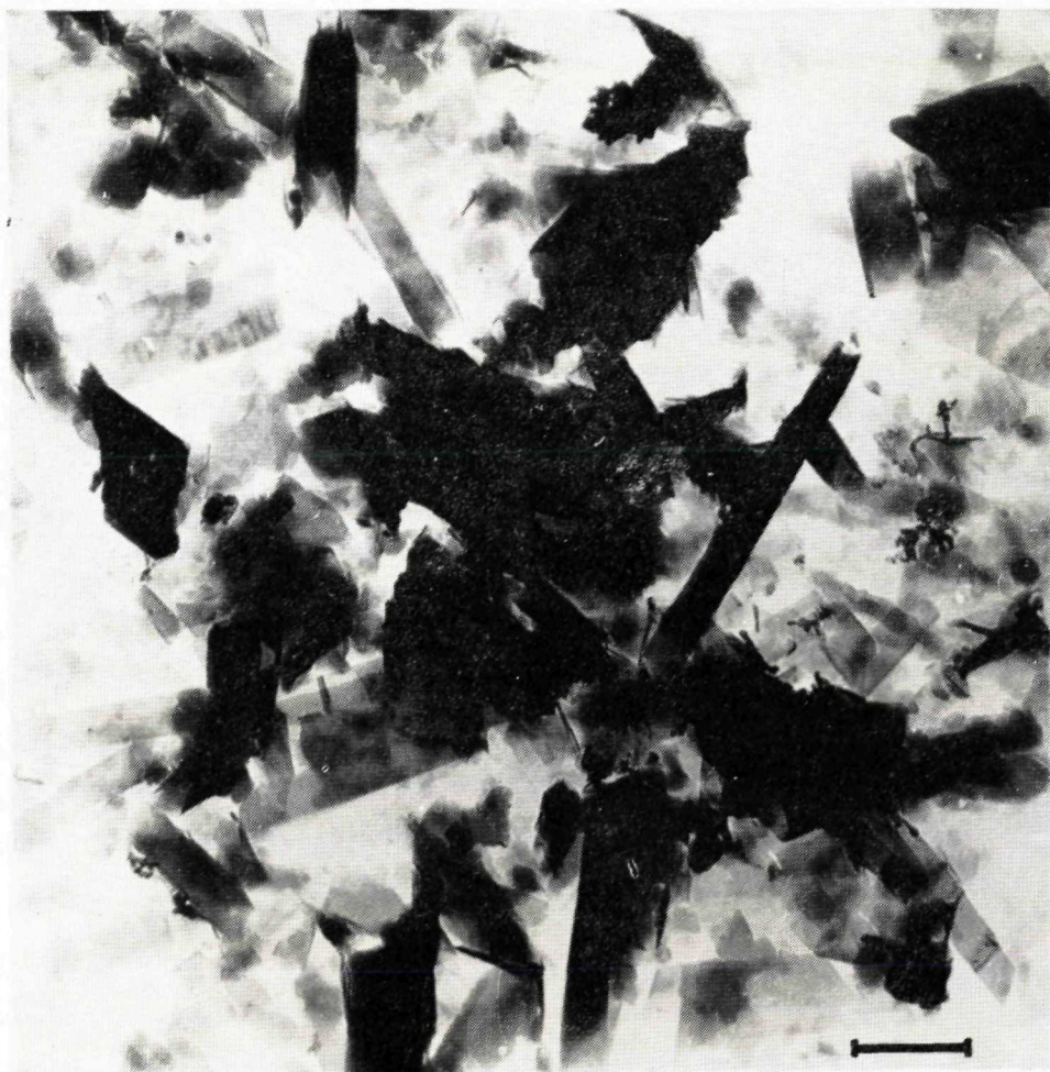
Obr. 8. Sféroidy \text{SiO}_2 s 37 % \text{Al}_2\text{O}_3 po hydrotermálnom procese (350 °C 14 dní). Snímka elektrónovým mikroskopom
